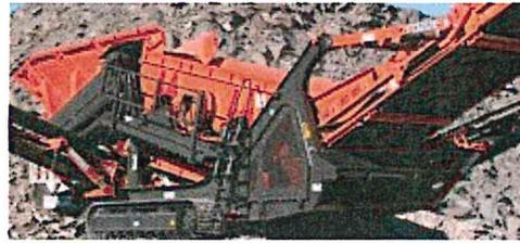
La conception du châssis du QE 341 a été inspirée par celle des concasseurs et entièrement conçue à l'aide des outils informatiques les plus modernes. Le résultat est un châssis extrêmement robuste, capable de résister aux chantiers les plus difficiles.
