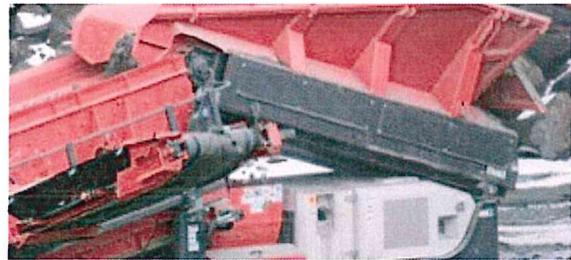
La trémie d'alimentation est montée sur un système coulissant qui permet d'ajuster le positionnement de la trémie en fonction de l'angle d'inclinaison du crible et de la descendre au point le plus bas afin de réduire sa hauteur en position de transport.
