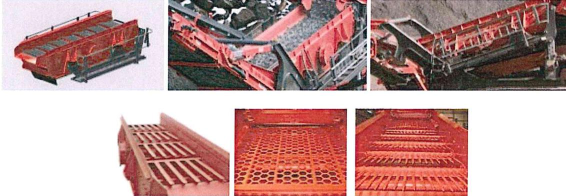
Le caisson de criblage à deux étages peut être équipé avec des doigts, du barreaudage, de la tôle perforée ou des grilles renforcées, ce qui permet à chacun de nos clients de trouver la solution idéale pour chacune des applications.
