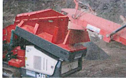
La trémie d'alimentation est montée sur un système coulissant qui permet d'ajuster le positionnement de la trémie en fonction de l'angle d'inclinaison du crible et de la descendre au point le plus bas afin de réduire sa hauteur en position de transport.
