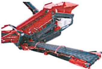
Le tapis intermédiaire à chevron de 650mm de large et 3 645mm de haut à 25° offre une grande capacité de stockage. Le convoyeur peut être inversé ou enlevé (Option : By-pass) afin de transformer la machine en crible deux produits.
