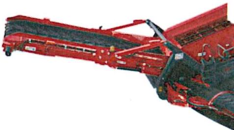
Le convoyeur de queue à chevron de 1 200mm de large est entraîné par deux moteurs hydrauliques. Il est possible de changer la configuration est de passer en mode deux produits avec une hauteur de stockage du convoyeur de 2 700mm.
