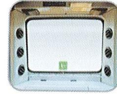
La fenêtre de sortie arrière est conçue pour faciliter une sortie de l'opérateur en toute sécurité.
