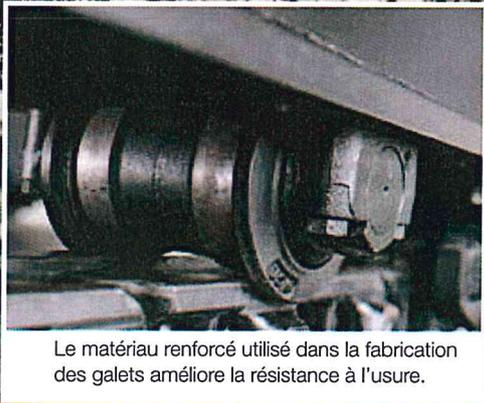
Le matériau renforcé utilisé dans la fabrication des galets améliore la résistance à l'usure.
